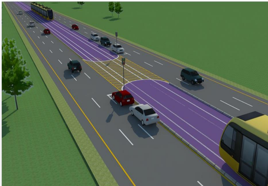
รูปที่ 5.6-34 ภาพจำลองการจัดกายภาพบริเวณจุดกลับรถ การติดตั้งสัญญาณไฟจราจร และเครื่องกั้น
