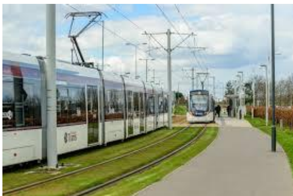
รูปที่ 5.11-7 ตัวอย่างการจ่ายไฟฟ้าเหนือศีรษะ
